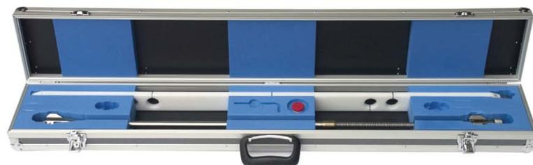
Déformètre de Forage et barre de guidage dans le coffret
