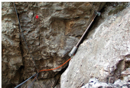
Surveillance d'un talus pendant les phases de tirs du tunnel de La Roche, (Suisse).
