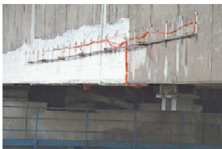
Instrumentation au niveau du tablier d'un pont avec une série d'extensomètres de surface ordonnés le long d'une ligne de déformation. Le mauvais état du pont oblige une surveillance continue ainsi qu'une étude des déformations du tablier effectuée pour cette dernière par le biais d'essais de chargement.
