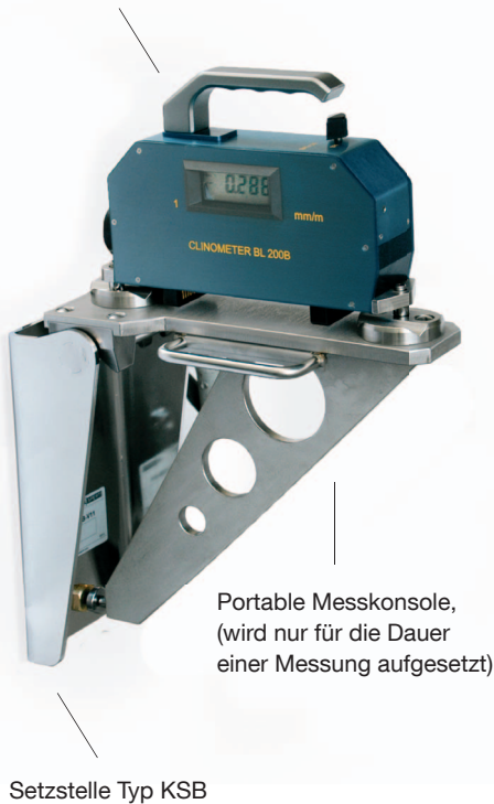
Clinometer BL200 A, Messbasis 200 mm
