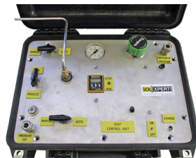
Unité de contrôle de la pompe, version à deux pressions (min = jusqu'à 17 bar, max = > 35 bar)
