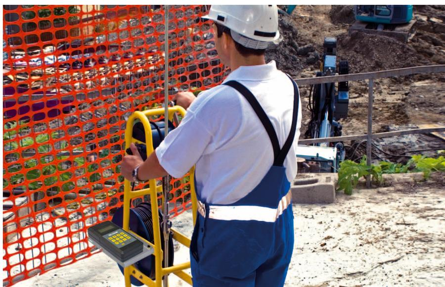
Mesure au Déformètre et Micromètre de Forage avec l'appareil MRD
