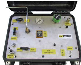
Pumpensteereinheit in zwei Versionen (niedrig = P bis 17 bar, hoch = P bis 35 bar)
