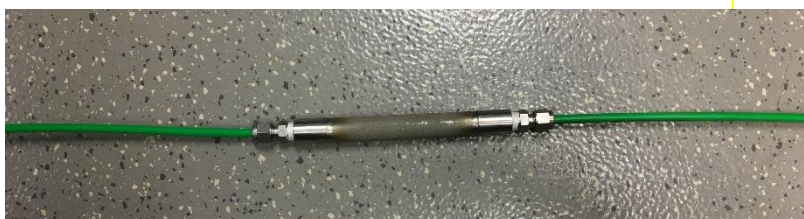
Exemple de capteur de mesure de pression hydrostatique BEM avec filtre de protection au niveau du point de mesure
