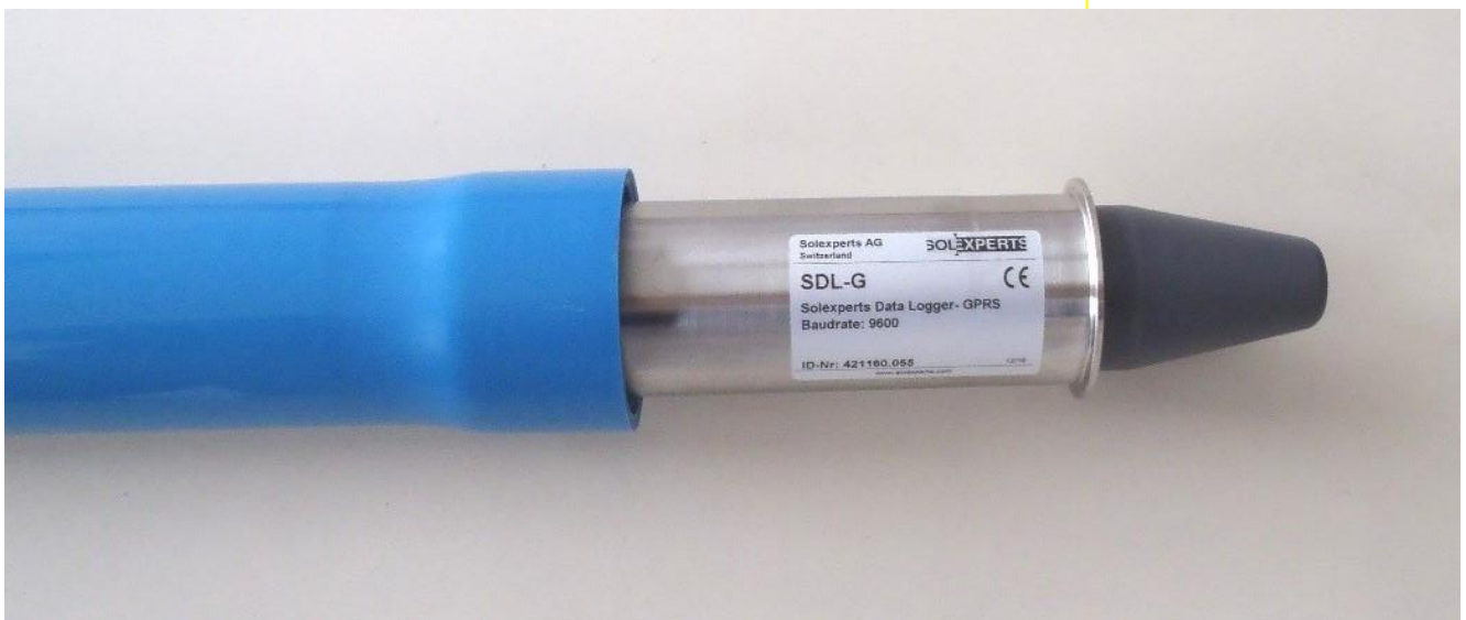
Data Logger versenkt im Piezometerrohr
