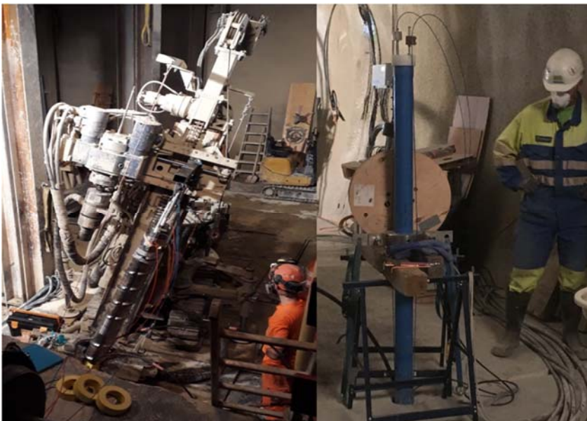
Mesures de déformation sur fibres optiques installées en forage, Gare de Bern (CH), Laboratoire de recherche MT Terri (CH)
