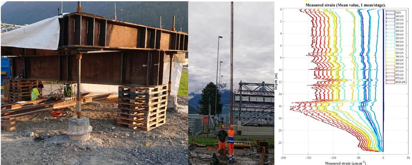
Verformungsmessungen bei Belastungsversuchen von drei Pfählen mit mehreren in der Bewehrung installierten Lichtwellenleiter, Bilten (CH)
