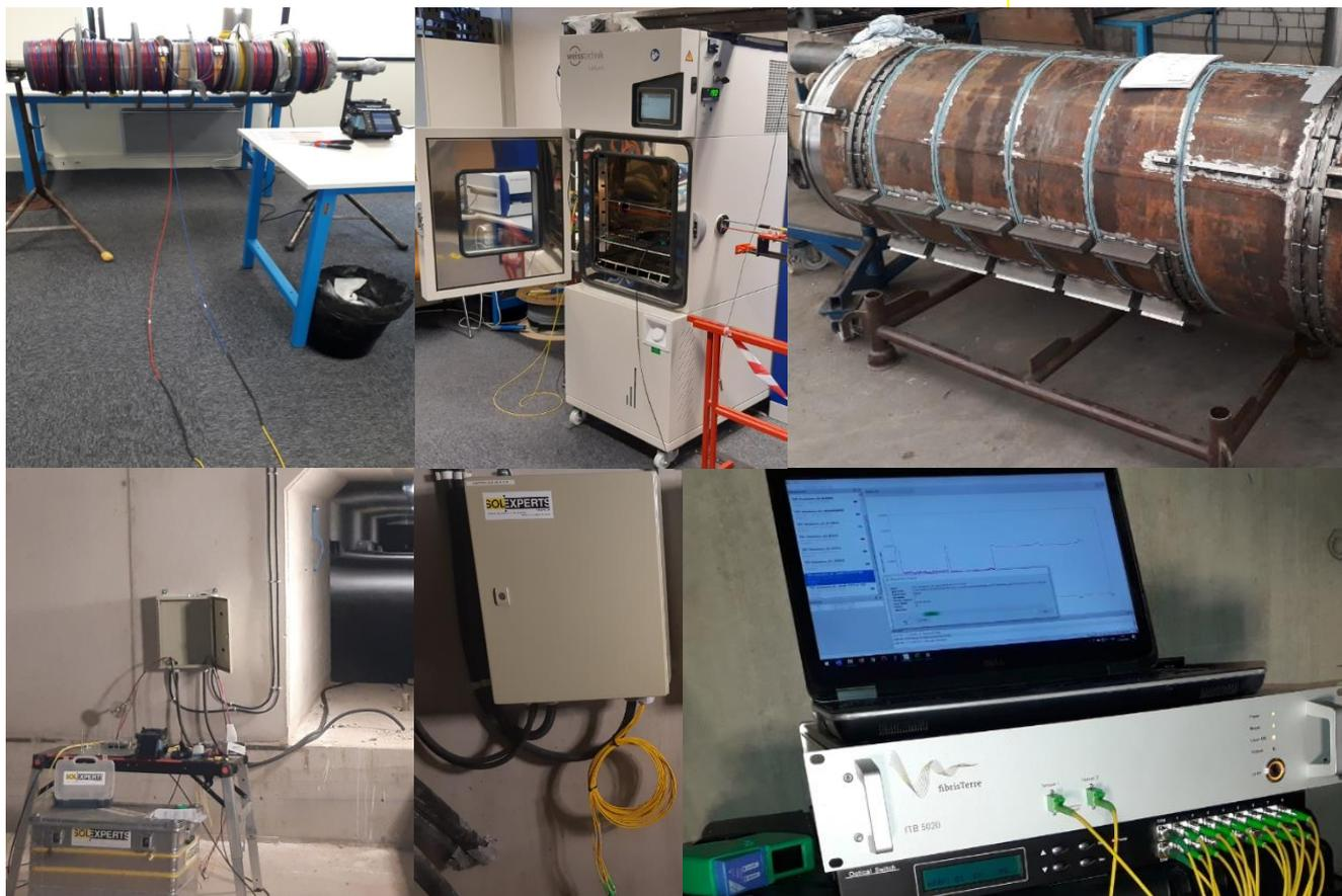
*Vorbereitung/Kalibrierung der Kabel in der Werkstatt, Installation am Bauwerk, Anschluss an den Interrogator*
