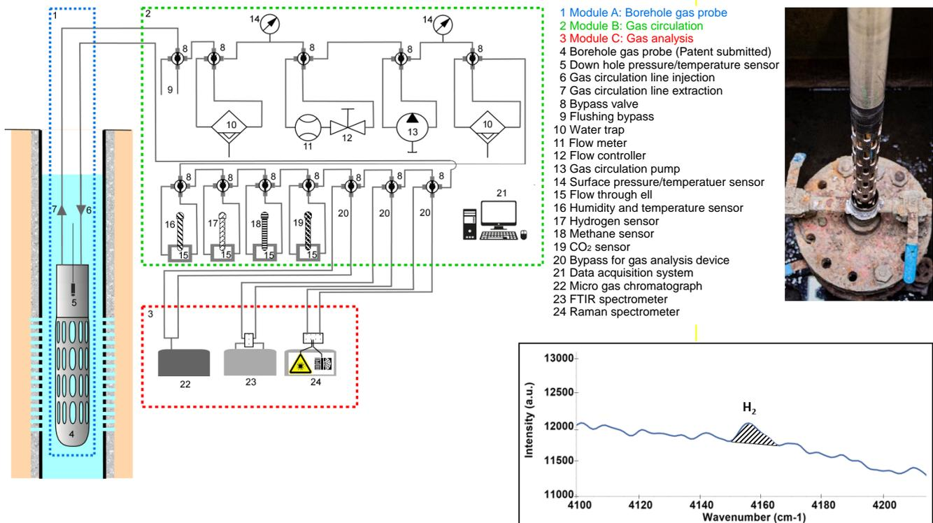
Principe SysMoG® mesures en continu - Spectre Raman mesuré in-situ en aquifère: Hydrogène dissous 0,17 mg/L
