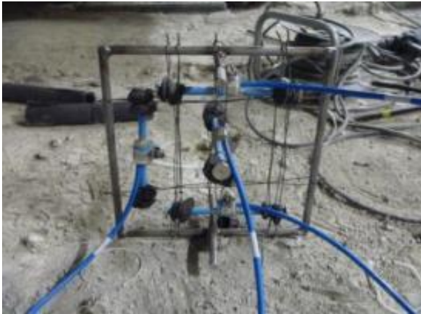
Installation d'extensomètres à corde vibrante (béton)
