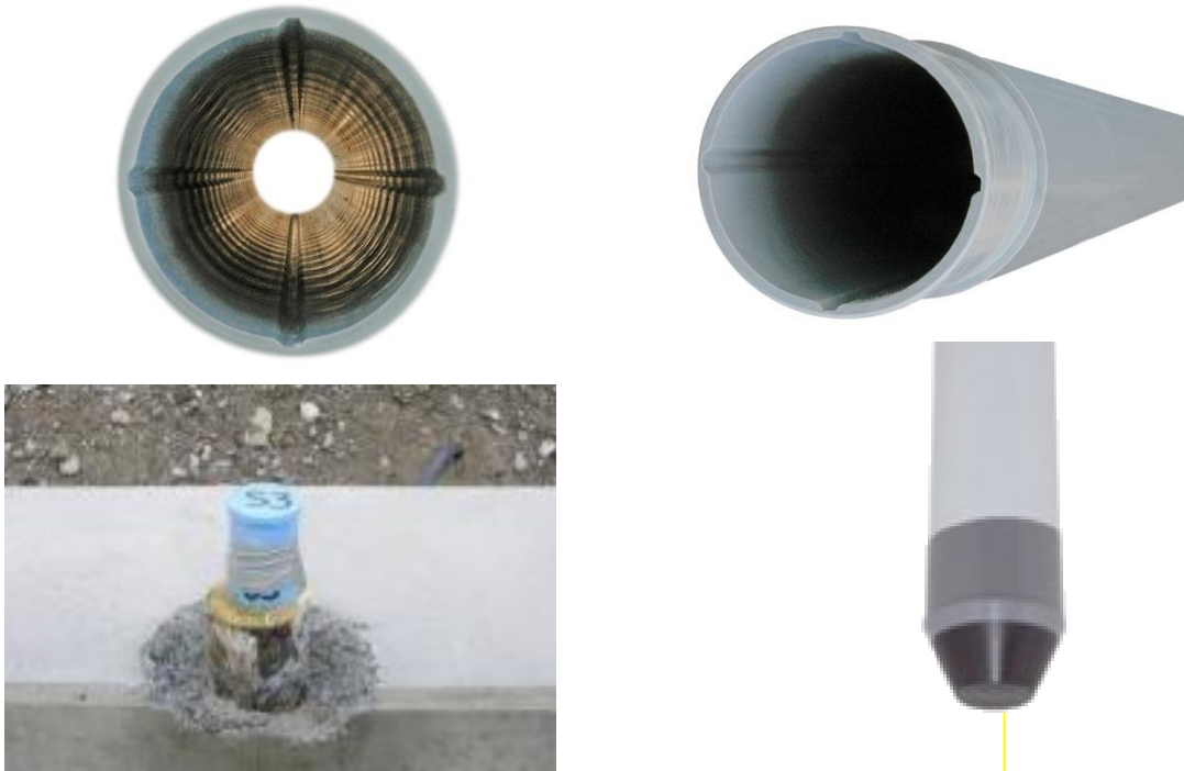
1. / 2. Tube de mesure inclinométrique rainuré 3. Fermeture inférieure 4. Bouchon de fermeture
