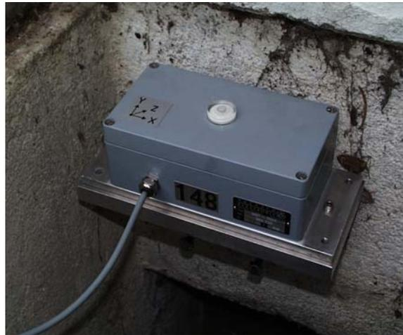
*Capteur de vibration triaxial utilisé
