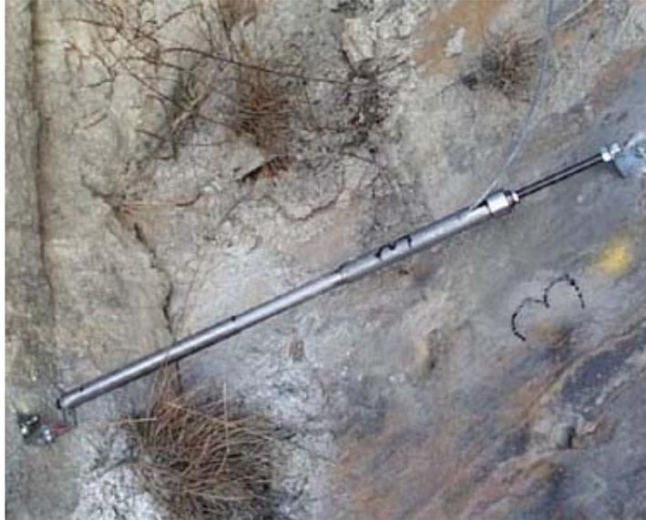
*Extensomètre de surface en place sur le site de Sceut (VS)*
