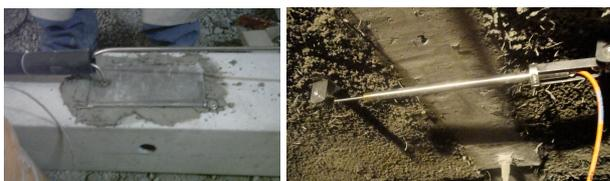
Photos n°4-5 : Cellule de pression totale et capteur de déplacement sur cale compressible (hiDCon®)
