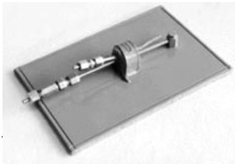
Bild 27 Erddruckgeber Glötzl, Kompensationsventil
