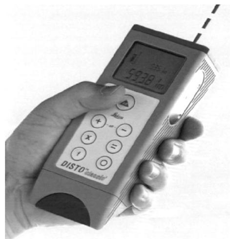
**Bild 3** Elektronische Distanzmessung
