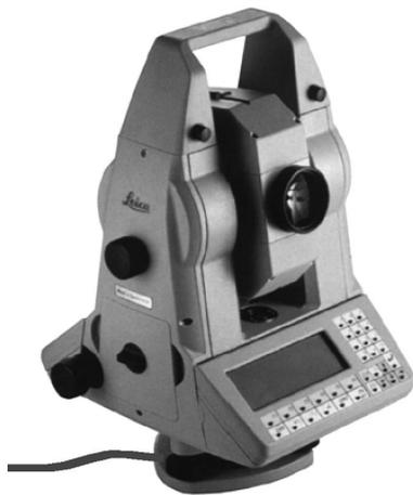
**Bild 2** Motorisierter Theodolit
