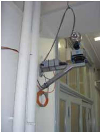
Abb. 3.2.6 Anordnung des motorisierten Digitalnivelliergerätes im Bahnhof St. Johann
