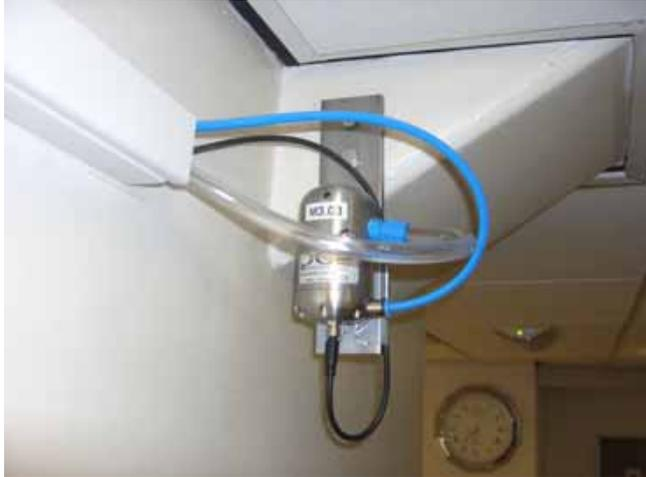
Abb. 3.4.4 Schlauchwaagen-Messstelle
