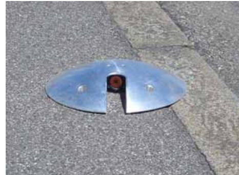
Abb. 3.2.3 überfahrbarer Messpunkt auf der Strasse der Strassen- und Trottoiroberfläche.
