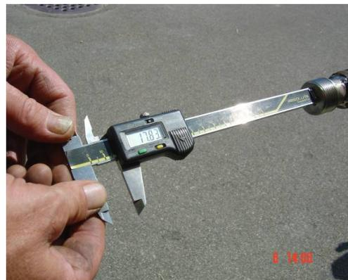
Abb. 7.7: Messankerkopf (links) und Messung mit Schieblehre (rechts)
