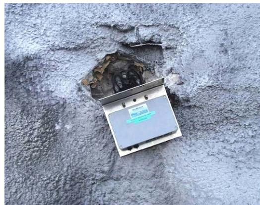
**Abb. 7.11:** Extensometermessung mit Messschieber resp. mit Interface zur Datenfernübertragung
