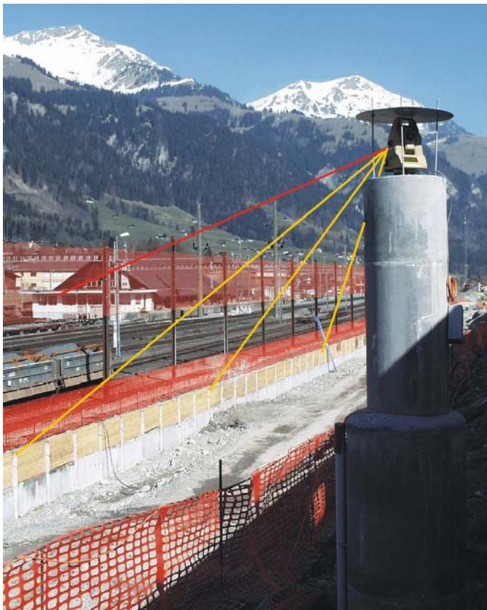
**Abb. 7.23:** Totalstation Frutigen zur automatischen optischen 3D Messung der Wandverschiebungen und von angrenzenden Gebäuden
