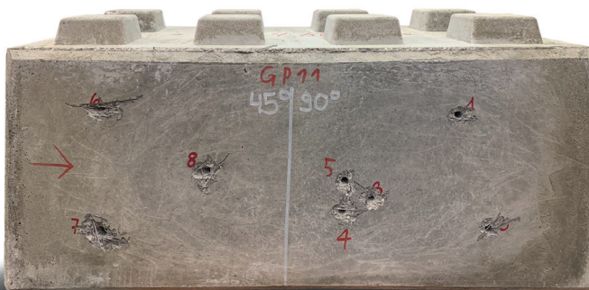
baLCon Element Typ A, Prüfung gemäss VPAM; GP11 (7.5 x 55mm) 90° & 45°
