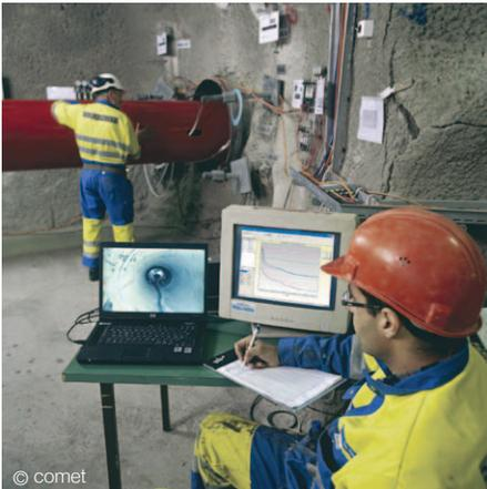
Das Solexperts GeoMonitor ist ein modular aufgebautes System zur automatischen Datenerfassung und Auswertung von vielen verschiedenen Sensoren.
