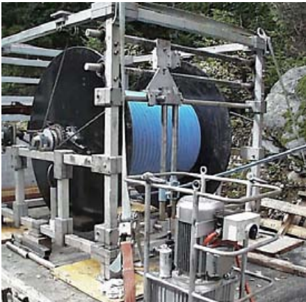
Winde mit Messkabel und Hydraulikaggregat auf Transportfahrzeug
