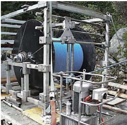
Treuil avec câble de mesure et agrégat hydraulique sur le véhicule de transport
