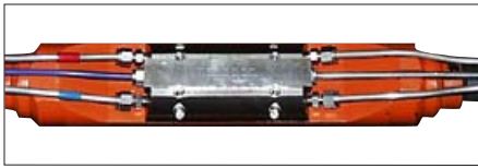
Raccordement du câble de mesure au système d'obturateurs
