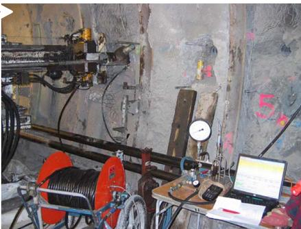
Essai au Dilatomètre
